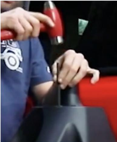
Con l'ausilio di un martello e di un cacciavite o cacciaspine, battere leggermente sui due fermi per far cascare il supporto
