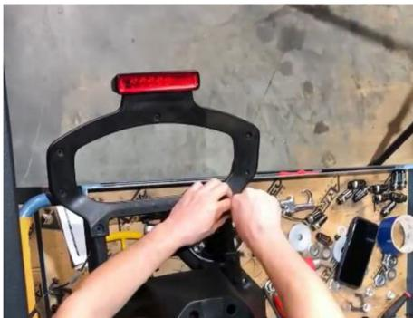
Rimuovere il cablaggio della terza luce di stop dal supporto porta ruota di scorta.
